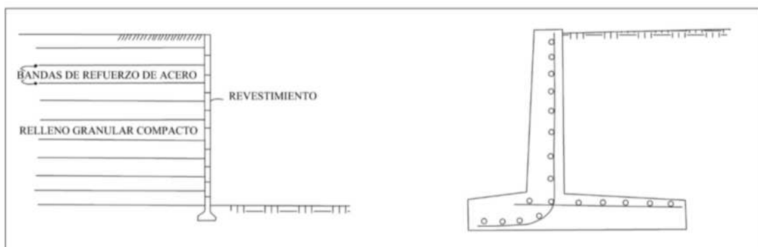
Muros de Tierra Armada
