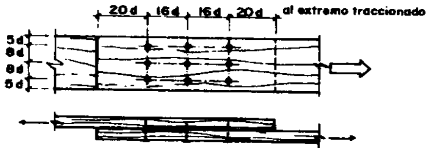
Fig. 10.2.5.2a. Elementos cargados paralelamente al grano.
